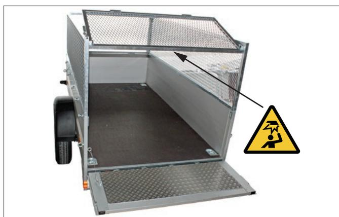
Stahlgitteraufsatz / Heck-Bordwand geöffnet
