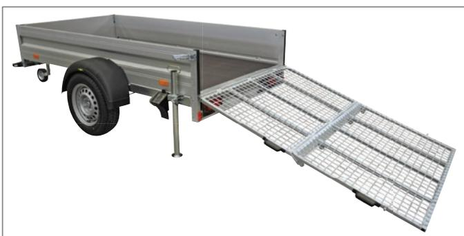
HA mit Überfahrwand (Stahlgitter) - abgelassen
