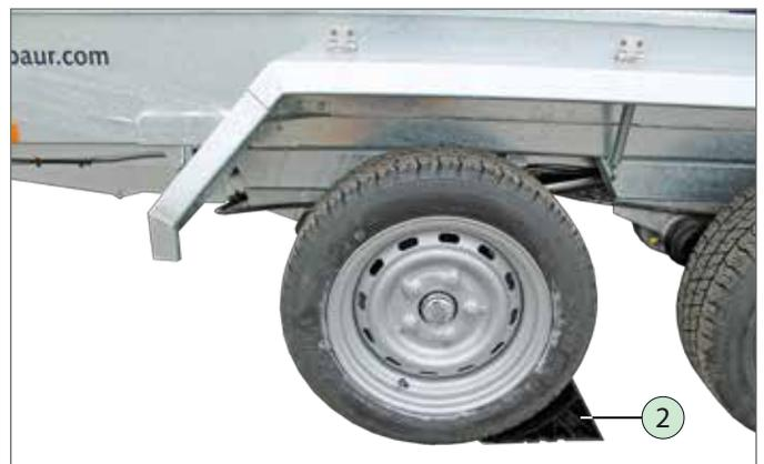
Unterlegkeil an starrer Achse, vorn
