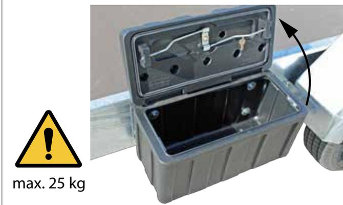
Werkzeugbox entriegelt & geöffnet
