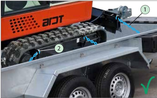
Beispiel „Kraftschlüssige Ladungssicherung“ / Mini-Bagger
