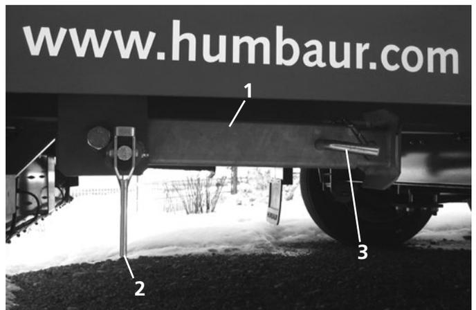
**Klappstütze am Heck in Fahrposition**
