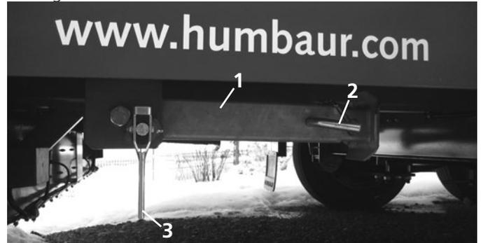
Klappstütze in Fahrposition
