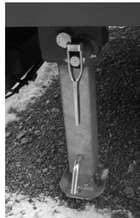
Klappstütze in Stützposition
