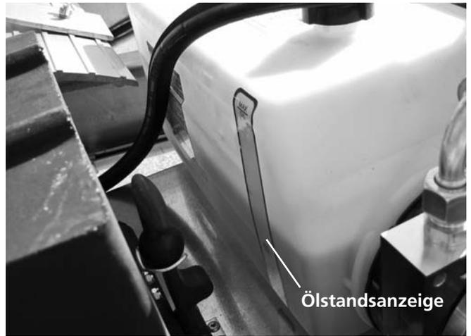
Ölstandsanzeige bei kombinierter Elektro- und Handpumpe
