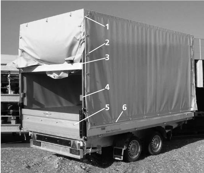
HTK mit Spriegelaufbau und Plane
